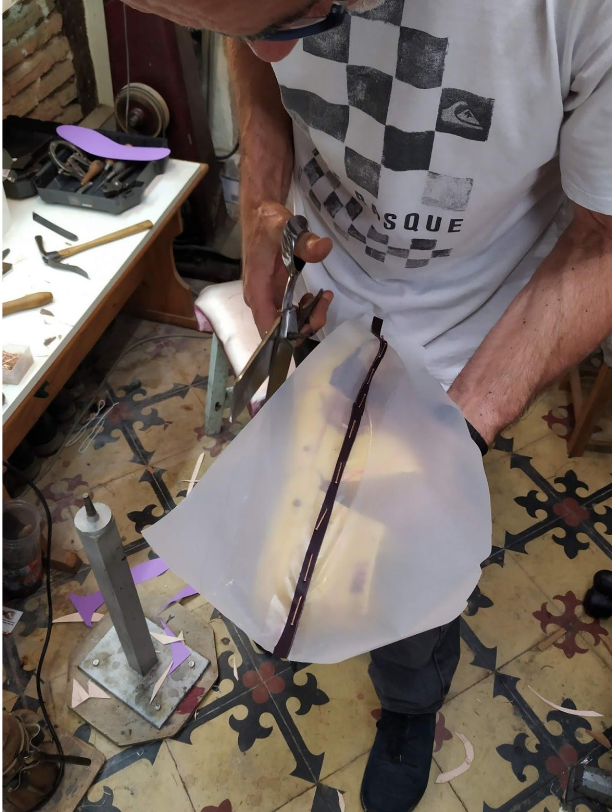
Dégrossissage du calque avant la coupe des "arêtes de poisson"
